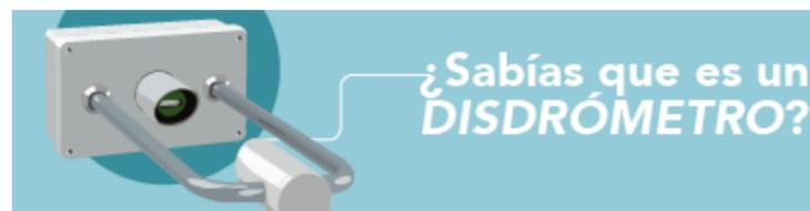
Es un sensor de precipitación láser que permite identificar el hidrometeoro de mayor tamaño registrado en cada minuto, y además separa la precipitación en líquida (llovizna y lluvia) y sólida (granizo).
